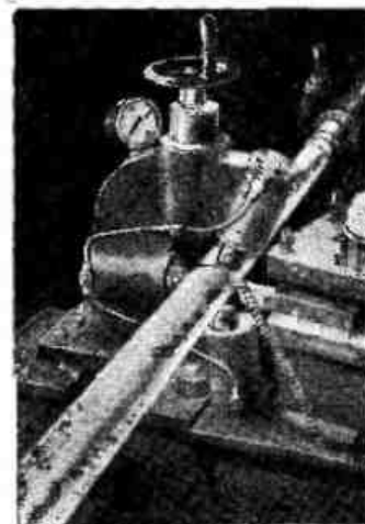
Рис. 59. Обработка длинного вала с виброгасителем
