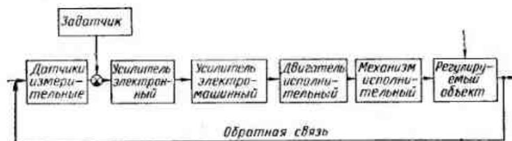
Рис. 24. Схема системы автоматического регулирования размера детали
