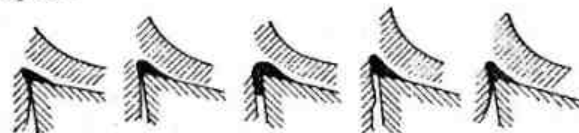
Рис. 36. Схема образования нароста
