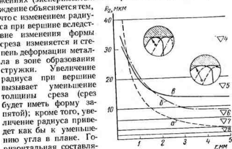
Рис. 37. Зависимость высоты шероховатостей R_z от радиуса r резца при вершине ( s = 0,35 мм/об): a — расчетная, б — v = 109 м/мин, в — v = 42 м/мин
