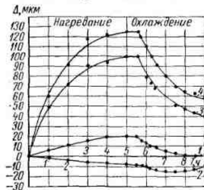
Рис. 19. Кривые (1—4) изменения перемещений оси шпинделя токарного станка 1А62. (Схему измерений см. на рис. 18)
