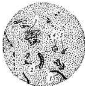
Рис. 2.29. Виды стружек, образующихся при шлифовании:
