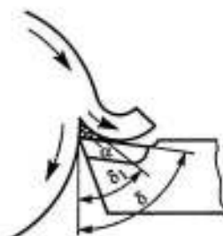
Рис. 2.7. Нарост на резце:
