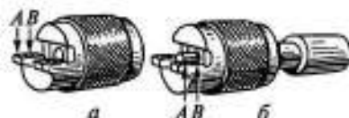
Рис. 4.38. Калибр-втулка для проверки наружных конусов (а) и пример ее применения (б):
