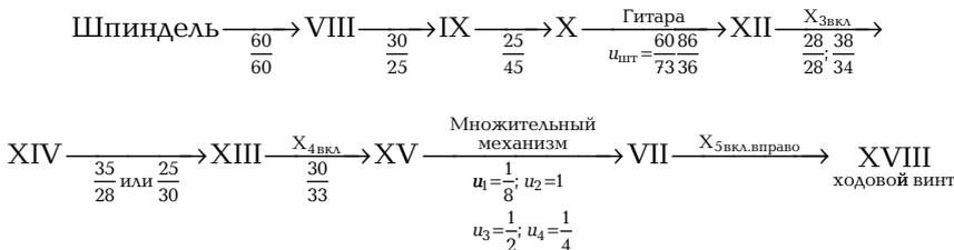
Включение звена увеличения шага позволяет увеличить количество подач, так как в этом случае происходит зацепление зубчатого колеса 45 вала III с колесом 45 вала VIII и движение передается от шпинделя в обратном направлении через перебор или колеса  $\frac{60}{30}$  на механизм подач с передаточными отношениями:
